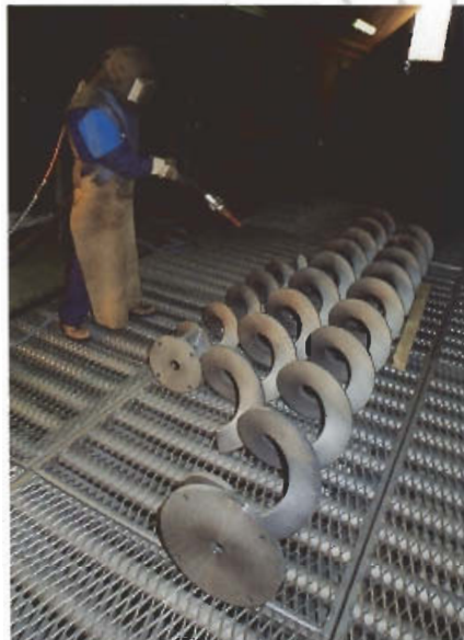
Cabine de sablage Sand blasting room
